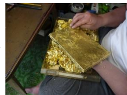
金粉をつけた真綿(まわた)を使い更に表面を滑らかに伸ばします。これにより下地が完全に金箔で覆われます。
