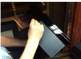
木地を作り、下塗、上塗を経て数日かけ乾燥。わずかな塵や埃も付着させないよう注意を払います。
