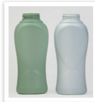
左) 再生樹脂を50%ブレンドした試作品 右) リサイクル材使用ボトルの表層に白着色のバージン材を用いたボトル
