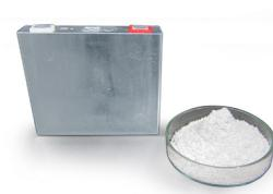
ニオブを負極材に用いた次世代リチウムイオン電池
